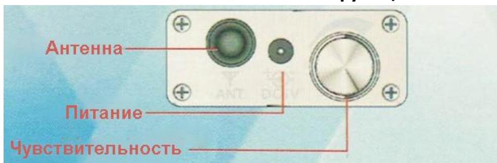
Левый порт на верхней панели детектора предназначен для антенны, средний – разъем питания. Справа находится ручка регулировки чувствительности. Поверните ручку по часовой стрелке, чтобы увеличить уровень чувствительности и против часовой, чтобы уменьшить.
