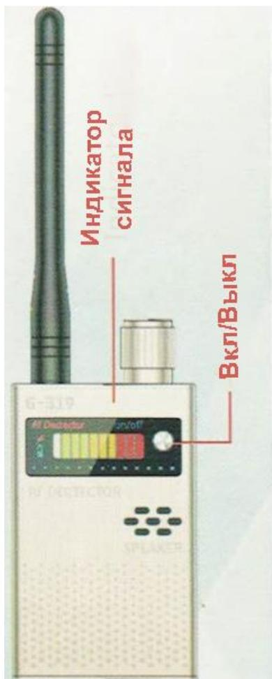
Индикатор сигнала - 10-уровневый индикатор, показывающий силу обнаруженного сигнала. Передвигайтесь с детектором поля по помещению, пока не обнаружите точку с наибольшим уровнем сигнала. Там и будет находиться его источник. Если полоса индикации будет заполнена, прозвучит звуковой сигнал. Чем чаще звучит сигнал, тем обнаруженный радиосигнал сильнее.
